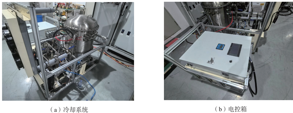
图10 高能光纤激光器浸没式相变冷却系统工程样机
